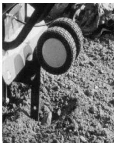
Рабочее положение колес и сошника
